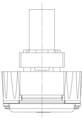
*24V avec motoréducteur de **55 RPM à 125 RPM***
